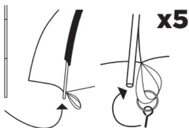
Вставьте стойки (дуги) в специальные "карманы" на тенте. Зафиксируйте свободные концы стоек в отверстиях фиксаторов. Зафиксируйте противоположные концы стоек таким же образом, приложив усилие.
